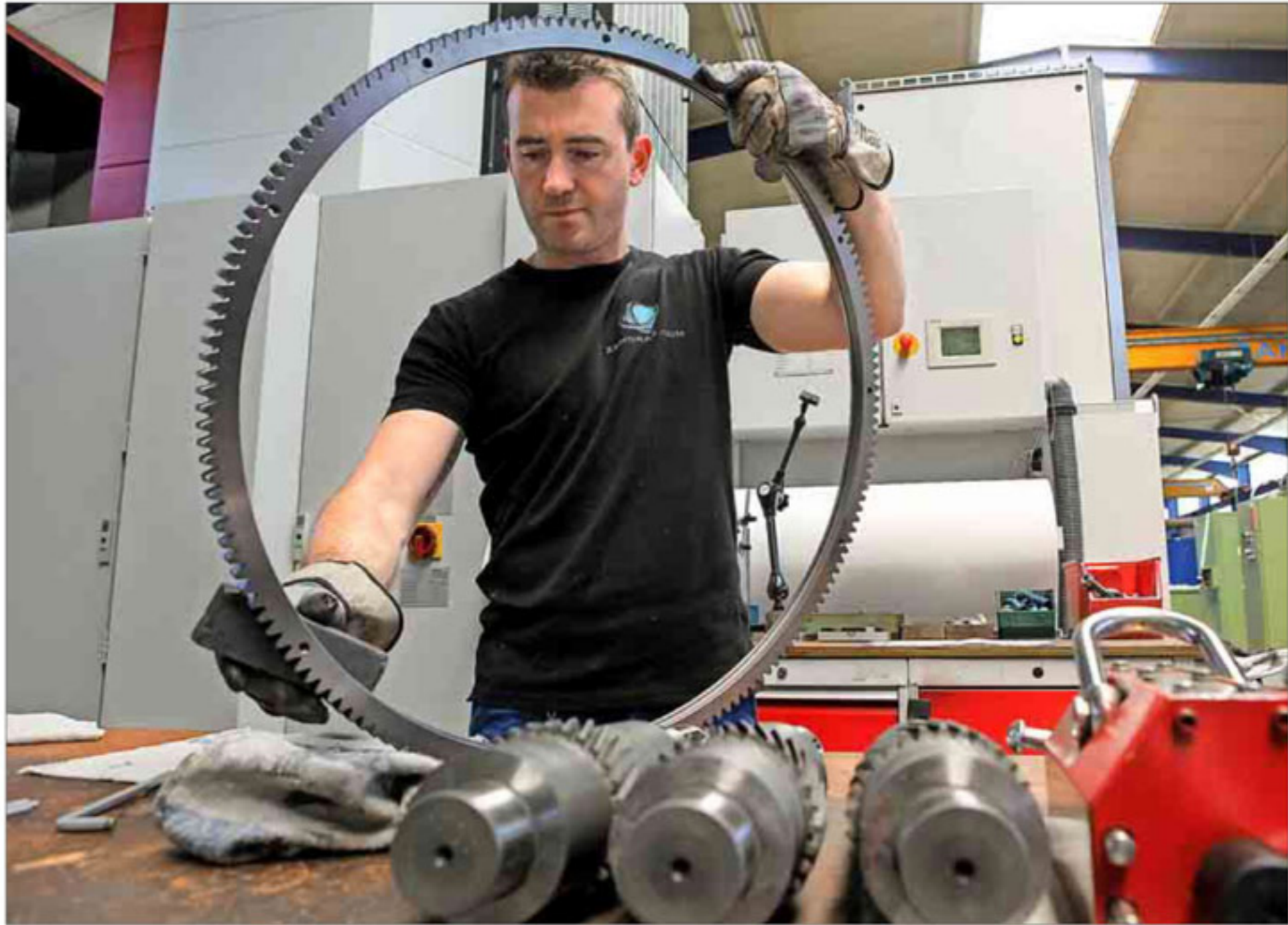
Ein Mitarbeiter poliert einen fertigen Zahnkranz.
