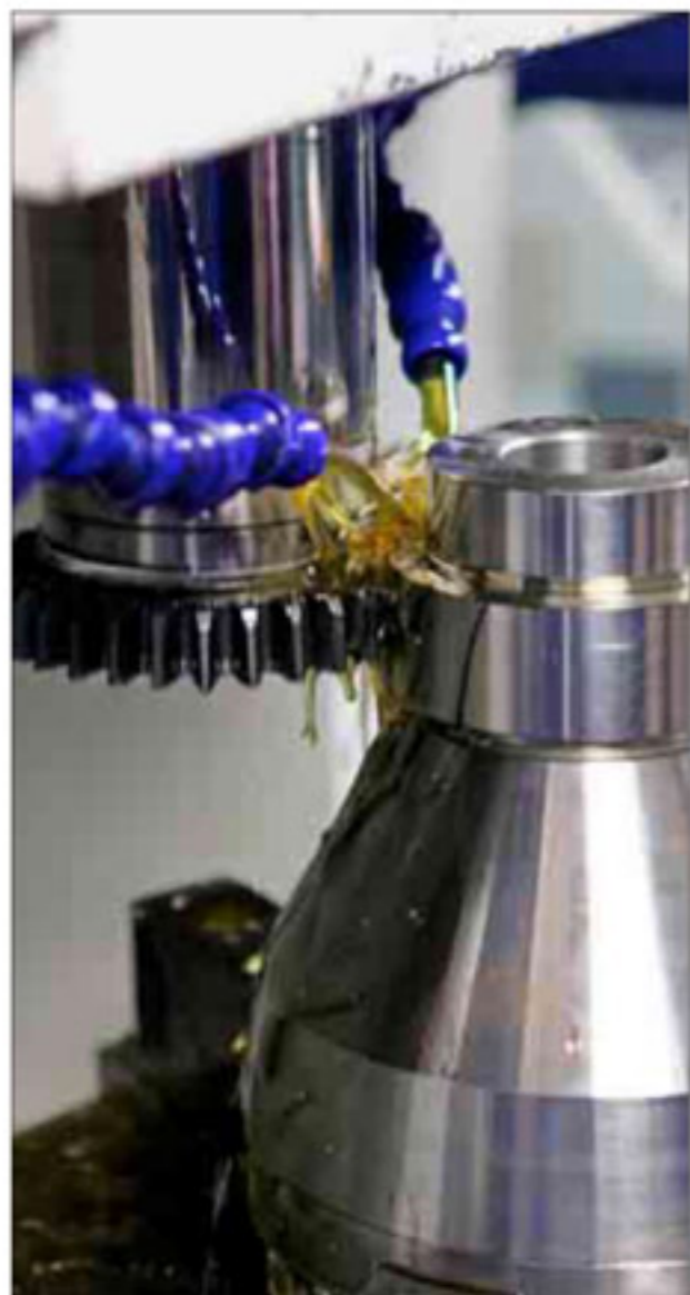
Unter Öl werden in ein rohes Drehstück (rechts) Zähne eingeformt.
